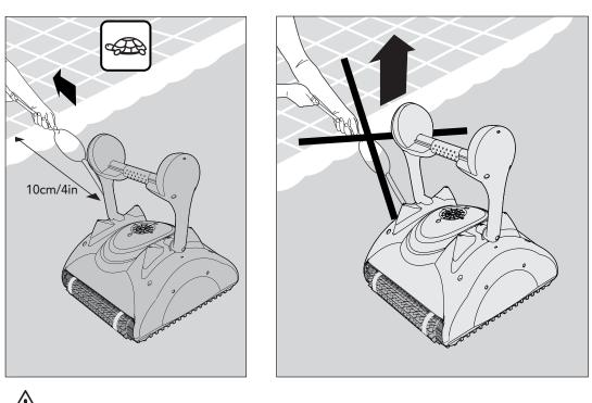
DO NOT PULL THE POOL CLEANER FROM THE POOL USING THE CABLE.
